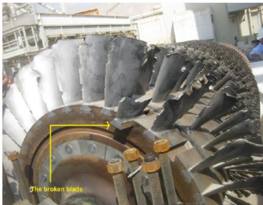
شکل 3. شکست پره در اثر کارکرد زیاد [42]
