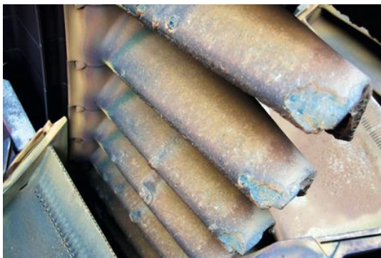
شکل 6. شکست نوک پره‌ها به دلیل کار در دمای بالا
