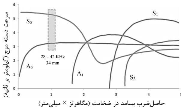
شکل ۲ خم‌های پراکنش موج برای یک محیط فولادی [۱۴]
