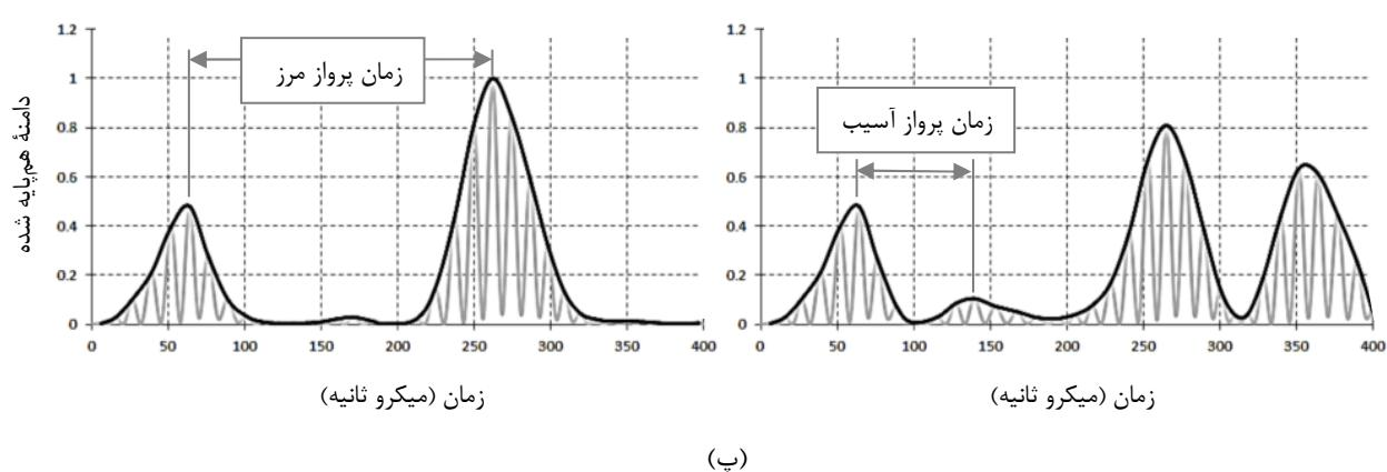
شکل ۸ فرایند آسیب‌شناسی با استفاده از تکنیک زمان پرواز. (الف) سیگنال‌های پیش‌پردازش شده، (ب) بسته‌های انرژی سیگنال‌های (الف) بدست آمده از تبدیل پیوسته موجک، (پ) توان میانگین مقیاس شده سیگنال‌های قسمت (الف) با استفاده از مقیاس‌نگارهای قسمت (ب).
