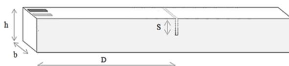
شکل ۱ شمای کلی تیر ضخیم مورد بررسی شامل یک ترک نمونه
